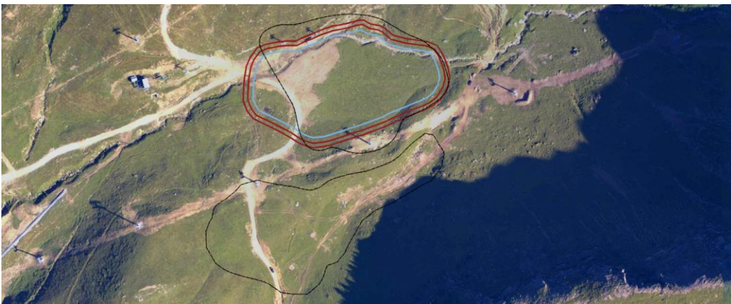
Planimetria della geometria ottimizzata del bacino in progetto a confronto con le alternative esaminate.
